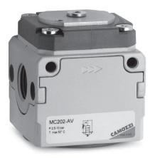
Клапан "мягкого" пуска позволяет избежать поломок оборудования и травмирования персонала при включении пневматической системы с цилиндрами. Клапан "мягкого" пуска делает возможным постепенно увеличивать давление в пневматической системе до 50% от входного значения, послечего величина давления скачком увеличивается до магистрального (100%). Обычно клапан "мягкого" пуска устанавливается после блока подготовки воздуха.
